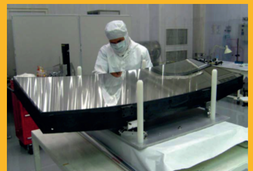
Comprobación final de uno de los espejos primarios de Gaia
